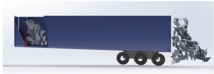
FIGURE 3 – Schéma de la benne pousoir en 95m<sup>3</sup>
